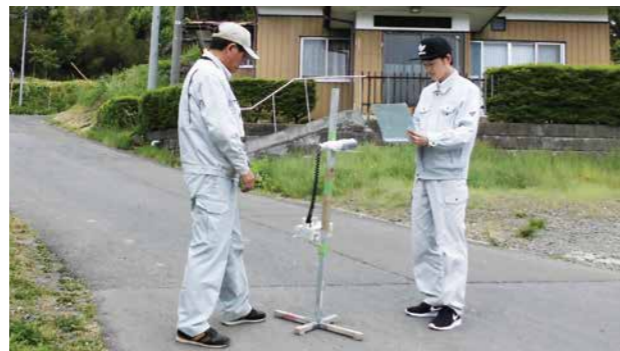
▲市内全域を1km四方に区切り（1kmメッシュ）、市内168箇所に分けた地域の放射線量を測定する職員
