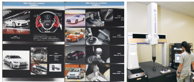
▲自動車の高級感や実際の手触りがグレードアップする本革の内装 ▲成形したノブを検査する三次元測定器
