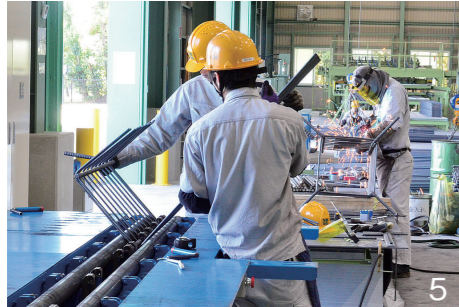
1_メークス株式会社東北工場の外観 2_製品・資材の保存スペースと、鉄筋加工スペースがある内観 3_9月28日、完成した東北工場を見学する関係者たち 4_ユニット鉄筋。現場加工しなければならない従来の基礎鉄筋とは異なり、工場加工したもののため、現場での施工が容易 5_ユニット鉄筋を用途やサイズに合わせて加工する作業。写真手前は、鉄筋を平行に並べて折り曲げて加工する作業で、写真奥は、溶接加工作業の様子
