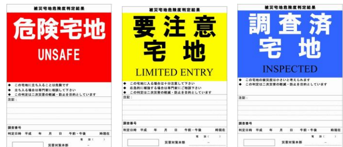
(例) 宅地の危険度判定のステッカー
