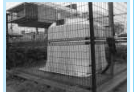
防災科学技術研究所が設置している強震計(白石市亘理町地内)
